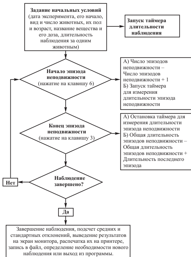
Рис. 1. Блок-схема программы для регистрации длительности неподвижности при изучении поведения животных во время вынужденного плавания по Порсолту.
